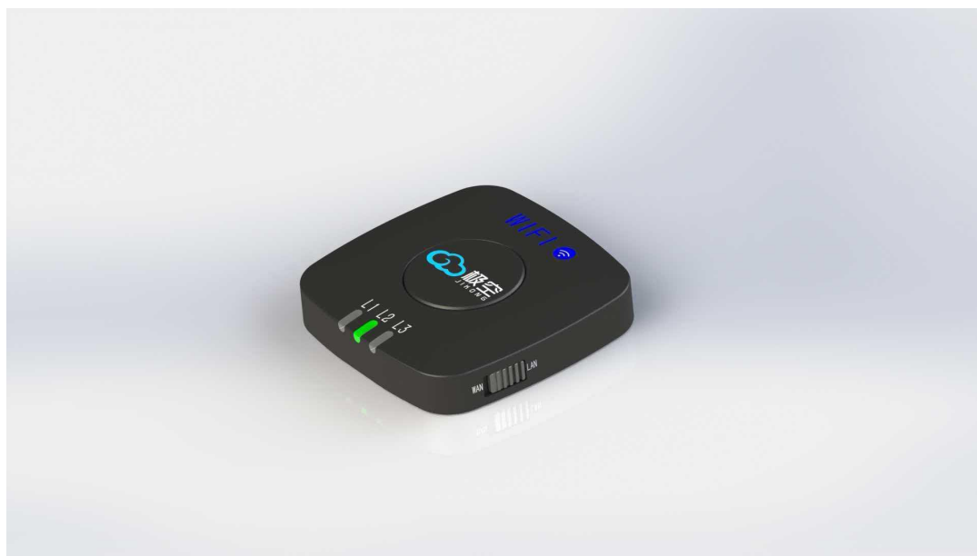
图 4.2.4 L2 常亮 L3 熄灭（连接路由器成功）
